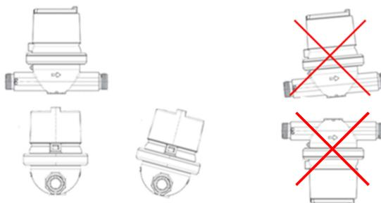
Nota: Se debe asegurar un tramo recto antes del medidor de al menos 3 veces el diámetro nominal del medidor (3xDN).
